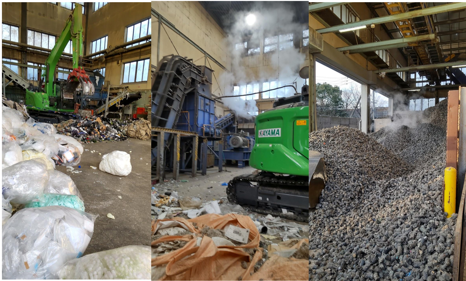
A県 K興業におけるRPF（Refused Plastic and Paper Fuel）製造 2022.1.19 写真竹谷
