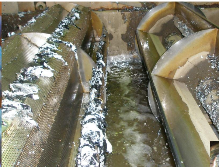
破碎プラスチック洗浄比重分離槽
